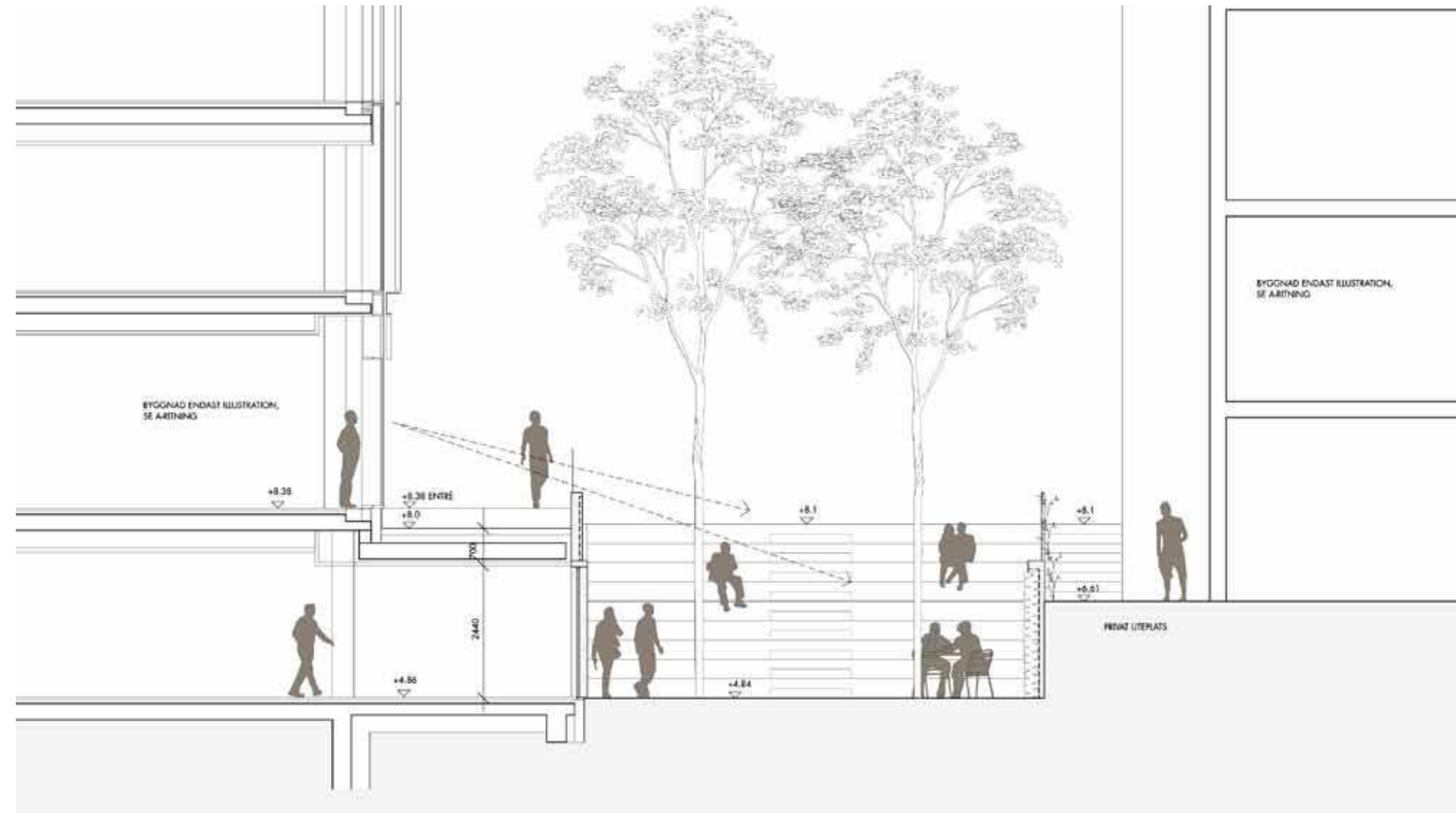
Tvärsektion genom Sofi Almquists Plats, mot väster. Den nedersta våningen inom Riddaren 18 utökas mot platsen och öppnar sig mot den försänkta trädgården.
