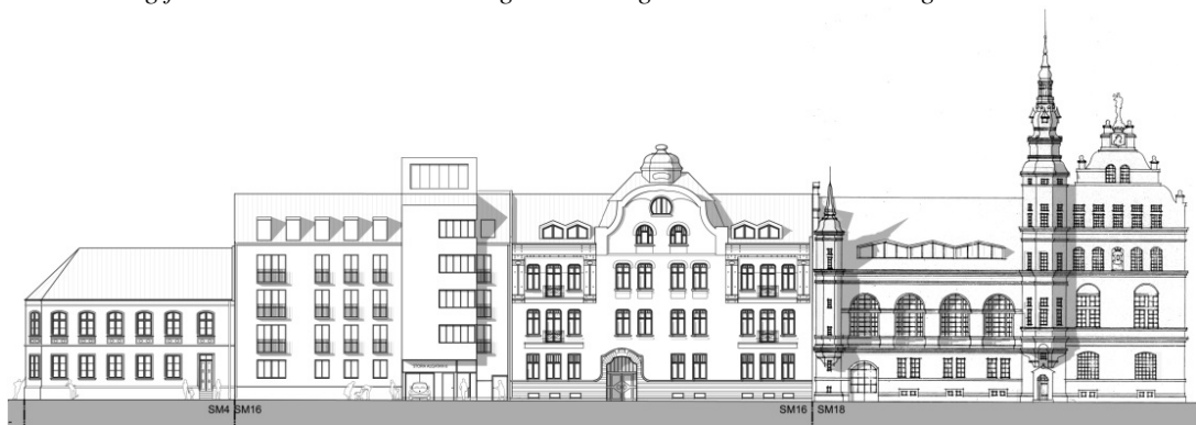
Fasadritning för kvarter Sankt Mikael längst Stora Algatan med nytt hus inritat. Ritningen ovan visar en möjlig utformning. Utformningen av byggnaden bestäms i samband med bygglov.
